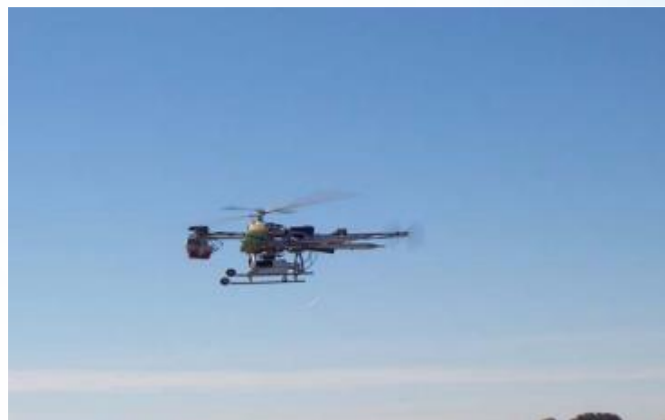
Размещение радиометра на борту беспилотного вертолета.
